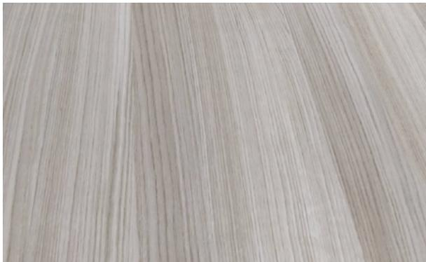
Eiche schlicht ohne Vlies – längsgefügt
