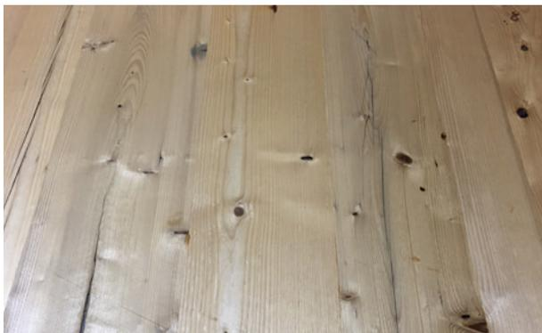
Fichte Alt mit Vlies – längsgefügt
